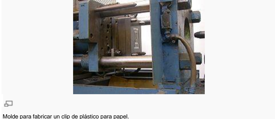
Molde para fabricar un clip de plástico para papel.
