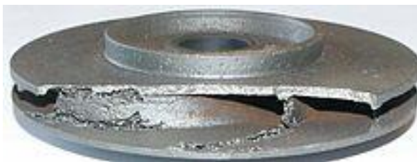
Ejemplo de desgaste producido por la cavitación en un rodete de una bomba centrífuga.
